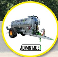
Advantage 10 000 l : roues 650/65R26.5, pompe MEC 8 000 l/min, Ecopump, pré-équipement pour outils d'épandage...
