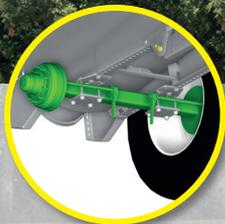
Train roulant boulonné pour adapter la balance du tonneau en cas de montage d'un outil arrière
